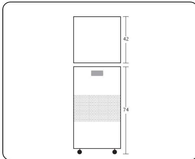
**DESCRIPCIÓN:** Papelera metálica con ruedas y dos asas. Cerco superior desmontable para sujeción de bolsas.
