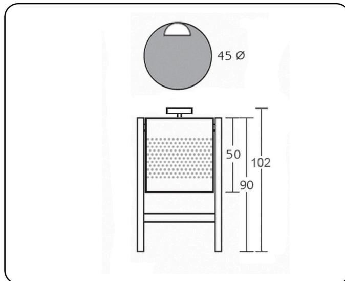
**DESCRIPCIÓN:** Papelera cenicero metálica para exterior perforada. Montada sobre bastidor para fijar al suelo. Sistema basculante para facilitar su vaciado.
