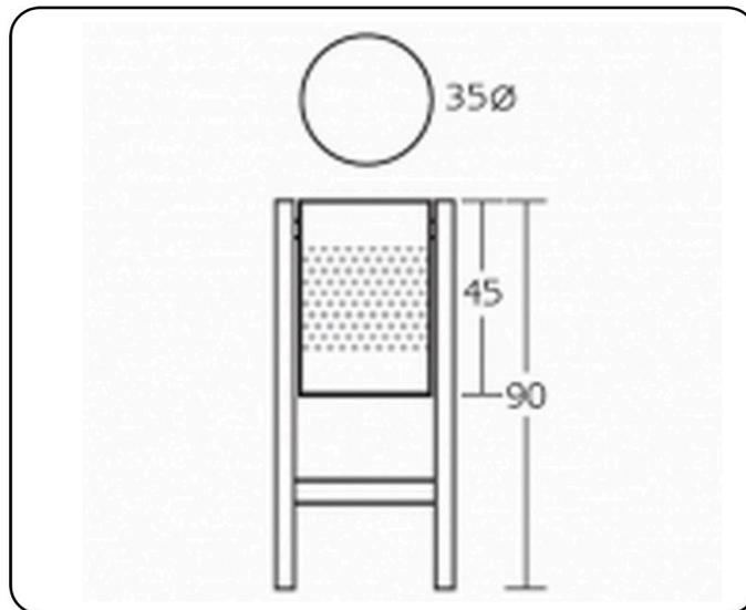
**DESCRIPCIÓN:** Papelera metálica para exterior perforada. Montada sobre bastidor para fijar al suelo. Sistema basculante para facilitar su vaciado.
