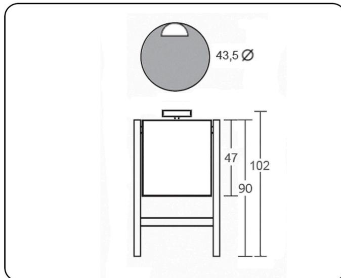
**DESCRIPCIÓN:** Papelera cenicero metálica para exterior. Montada sobre bastidor para fijar al suelo. Sistema basculante para facilitar su vaciado.
