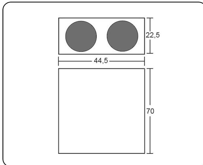
**DESCRIPCIÓN:** Papelera de reciclaje de acero inoxidable. Tapa superior desmontable con dos aberturas identificadas con colores. Adhesivos frontales identificativos del tipo de residuo. Dos cubetas interiores extraíbles para su vaciado. Embellecedor negro en la base.
