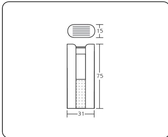
**DESCRIPCIÓN:** Papelera cenicero metálica perforada. Colillero metálico extraíble con tapa basculante de rejilla. Embellecedores negros en la base.
