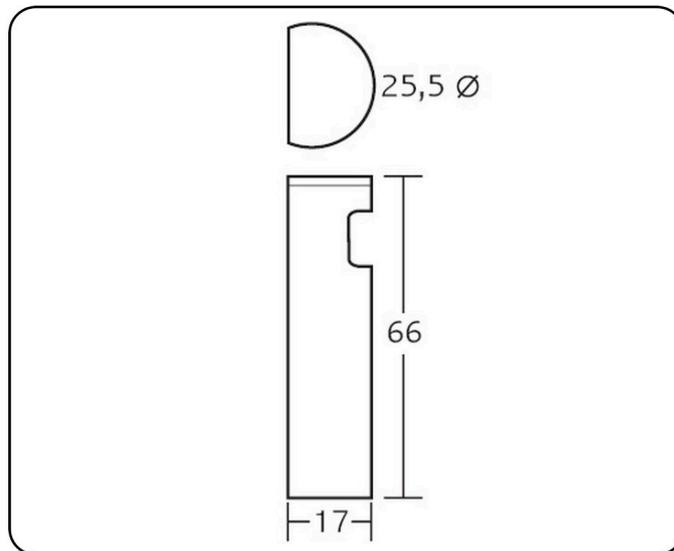
**DESCRIPCIÓN:** Papelera cenicero de acero inoxidable perforado. Colillero metálico extraíble cubierto por tapa de acero inoxidable perforada. Embellecedor negro en la base.
