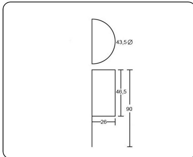
**DESCRIPCIÓN:** Papelera metálica para exterior. Montada sobre bastidor para fijar al suelo. Sistema basculante para facilitar su vaciado.
