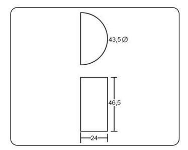
**DESCRIPCIÓN**: Papelera metálica para exterior. Montada sobre soporte para fijar a la pared. Sistema basculante para facilitar su vaciado.
