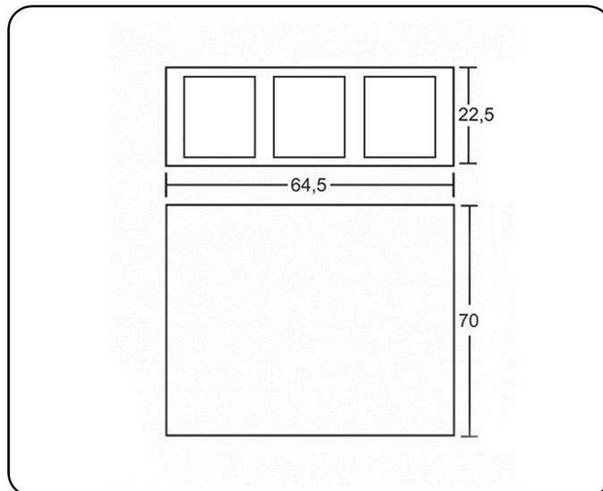
**DESCRIPCIÓN:** Papelera de reciclaje metálica. Tapa superior desmontable con tres aberturas abatibles identificadas por colores. Adhesivos frontales identificativos del tipo de residuo. Tres bastidores de varilla en su interior para sujeción de bolsas. Embellecedor negro en la base.
