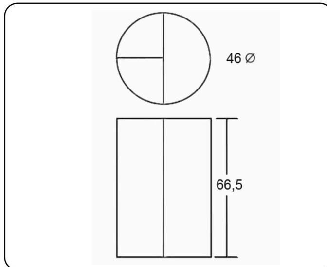
**DESCRIPCIÓN:** Papelera de reciclaje metálica. Tres cubetas extraíbles para su vaciado. Bastidor metálico. Embellecedor negro en la base.
