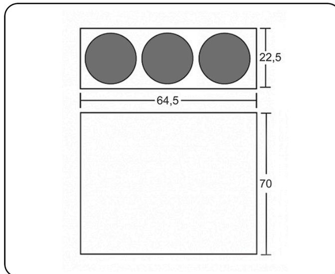
**DESCRIPCIÓN:** Papelera metálica selectiva de residuos. Tapa superior desmontable con tres aberturas identificadas por colores. Adhesivos frontales identificativos del tipo de residuo. Tres bastidores de varilla en su interior para sujeción de bolsas. Embellecedor negro en la base.
